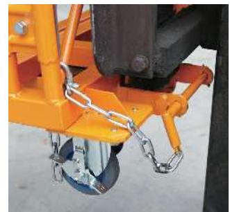
安全ロック(リフト下部)
