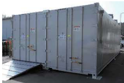
40フィート冷凍コンテナ 2台接続
