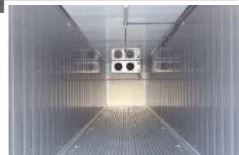
40フィート 冷凍冷蔵コンテナ内観
