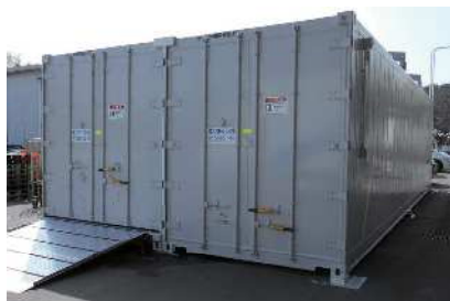
40フィート冷凍コンテナ 2台接続
