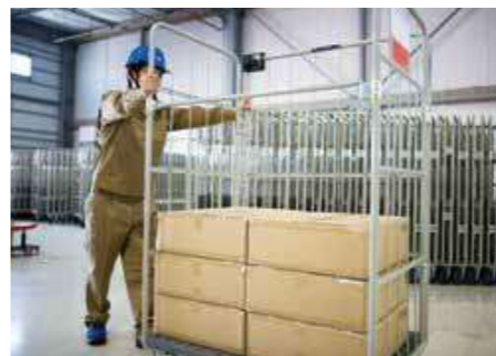
カゴ台車に取り付けた小型IoTデバイス(台車上部の黒い箱状のもの)が位置情報をクラウドに送信する「LP-WATS」。
