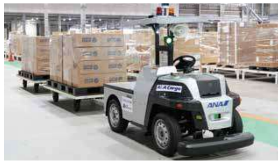
フォークリフトによる輸送業務が自動化され、1時間あたり最大24パレット(約4.8t)の安定した貨物輸送が可能となります。
